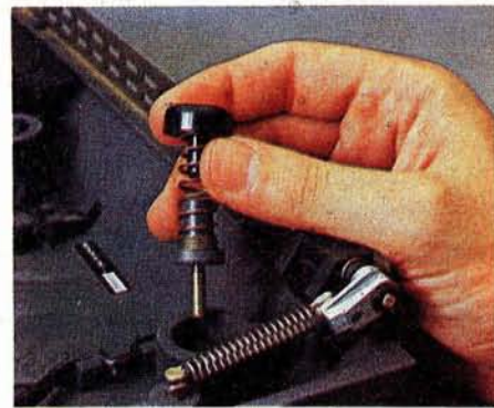
La sospensione della piastra è affidata a quattro semplici molle integrate da elementi in gomma.
