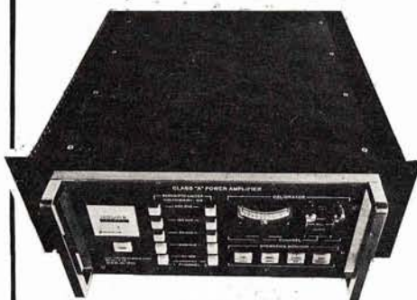
Amplificatore Electro Research A-75. La prima versione per impieghi audio, con i suoi cinque limitatori di banda.
