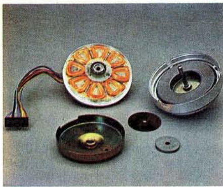
Il motore è un Papst a trazione diretta con 16 bobine di campo platte poste su due strati.
