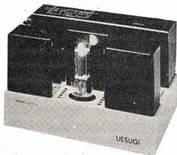
Amplificatore Uesugi UTY-1. L'artefice del mito Uesugi: una sola valvola alimentata a 1.000 volt; 100.000 lire a watt.
