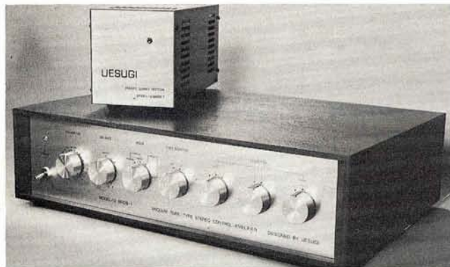
Preamplificatore Uesugi U-BROS-1. Le meraviglie delle valvole: 1.300 mV di sovraccarico e 60 V di uscita; Yen 360,000.
